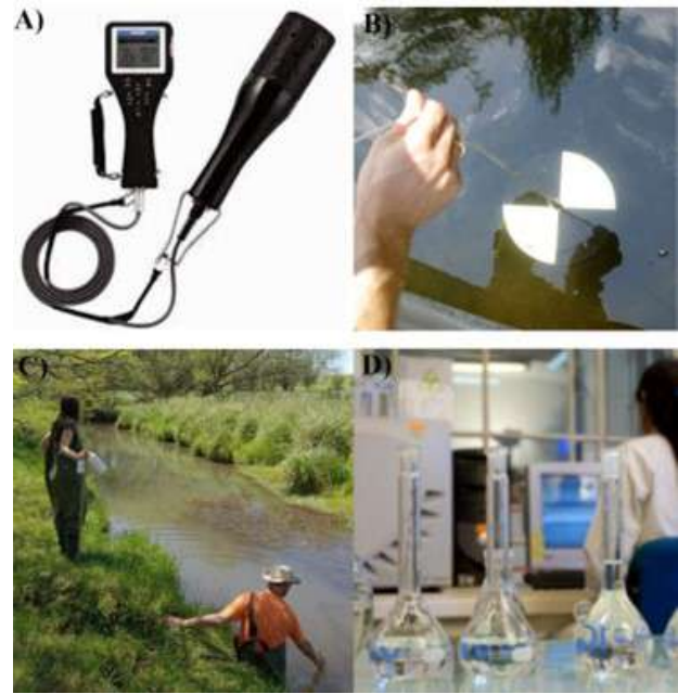
Fig. 4. Instrumentos utilizados para la medición de variables físico-químicas del agua. A) sonda multiparamétrica para medir in situ (directamente en el lugar) parámetros físico-químicos del agua, B) disco de Secchi para medir la transparencia del agua, C) recolección de muestra de agua, D) procesamiento de las muestras de agua en el laboratorio.
