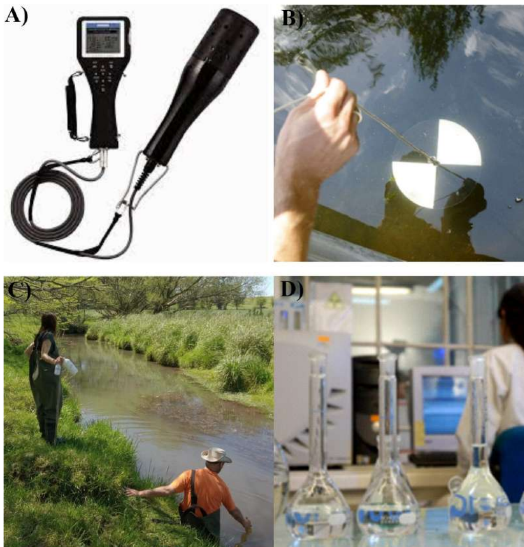
Fig. 3. Instrumentos utilizados para la medición de variables físico-químicas del agua. A) sonda multiparamétrica para medir in situ parámetros físico-químicos del agua (directamente en el lugar), B) disco de Secchi para medir la transparencia del agua, C) recolección de muestra de agua, D) procesamiento de las muestras de agua en el laboratorio.
