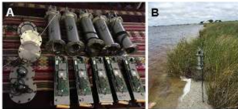
Figura 43: Detalle de hidrófonos (A); hidrófono montado en Mar Chiquita para ser sumergido dentro de la laguna. Fotos: M. P. Sal Moyano
