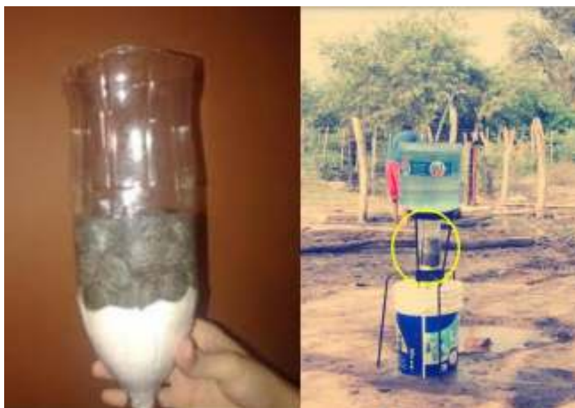
Figura 13: Filtro casero para agua
