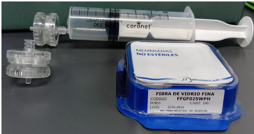
Figura 1. Elementos (jeringa, filtros y soporte de filtros) para filtrar la muestra de agua para análisis de DOC.
